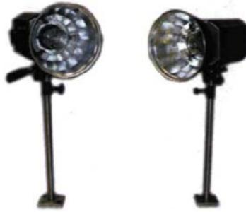
Figure 1- 7 : Deux lampes flash pour la thermographie infrarouge pulsée
