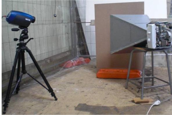
Figure 3- 9: Dispositif des essais de thermographie infrarouge sur échantillons en bois
