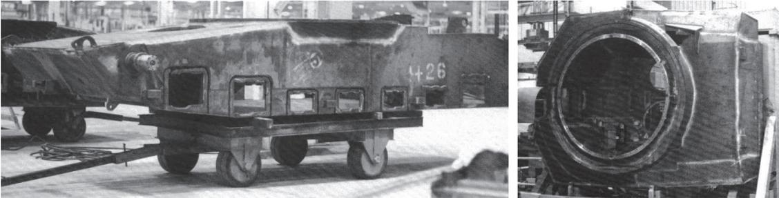
Figure 2 : Blocs d'assemblages du char M1 Abrams [52]
