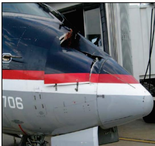
Un CRJ-700 a heurté un vautour noir pendant un atterrissage vers un aéroport dans le Kentucky, le 28 août 2007. L'impact a causé des dommages substantiels au nez de l'appareil.
