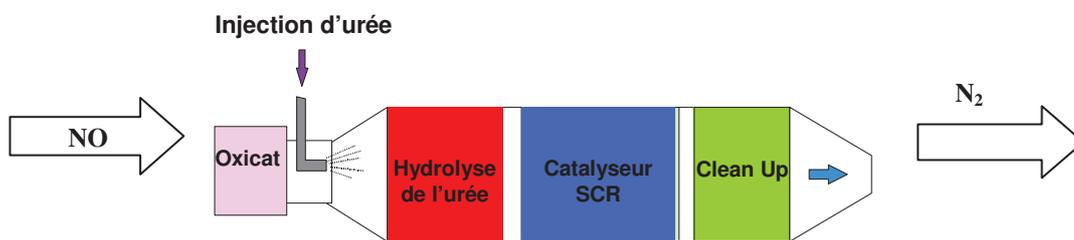
Figure 25 Schéma du fonctionnement de la Réduction Catalytique Sélective (SCR), comportant les différents systèmes de dépollution.
