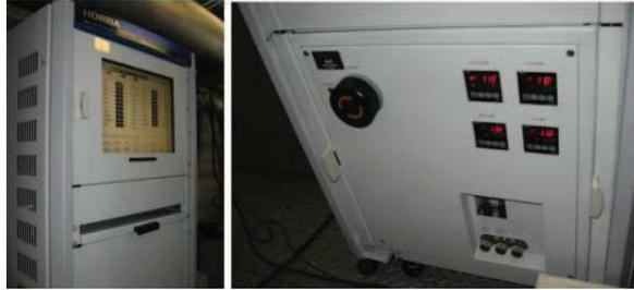
*Photo 2 FTIR Horiba, gauche : écran et clavier de contrôle; droite : Réglages des températures des lignes, pompe et filtre, et zone d'emplacement du filtre à particules en papier.*
