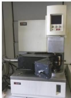
Figure 1 : Rhéomètre dynamique ARES
