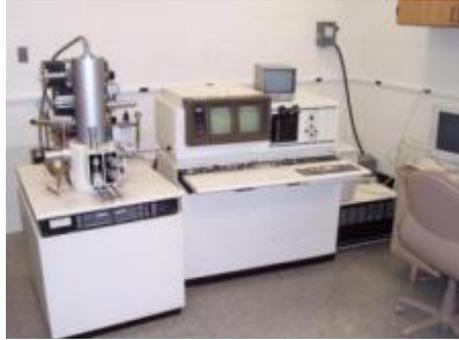
Figure 2 : Microscope électronique à balayage Hitachi S800
