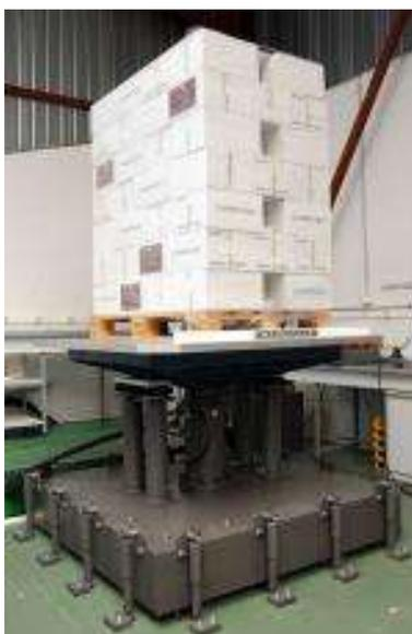
Figure 66 : Table vibrante hydraulique LANSMONT.
