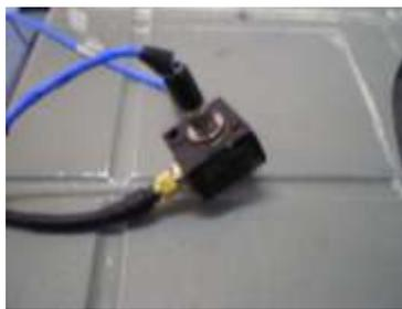
Figure 57 : Accéléromètre triaxial.
