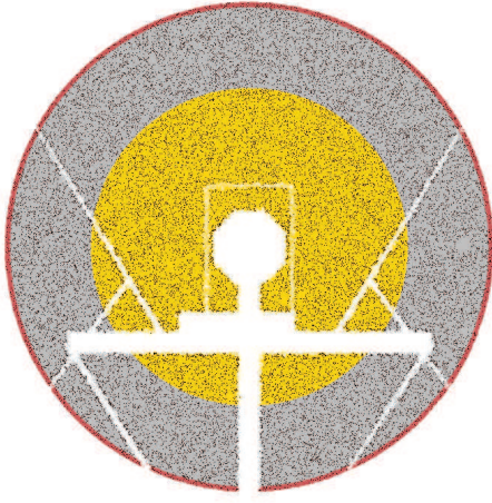
FIGURE 4.2: Points d'impacts des rayons solaires calculés avec le logiciel Soltrace sur le concentrateur
