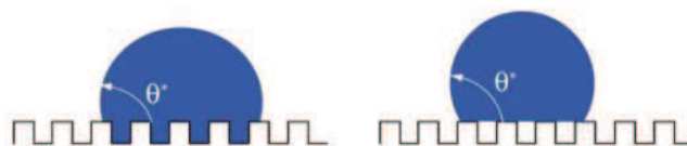
Figure 14- Schématisation du régime de Wenzel (gauche) et de Cassie Baxter (droite) 10
