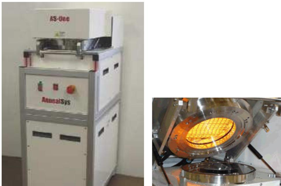
Figure II-2 : photo du four RTA As-One
