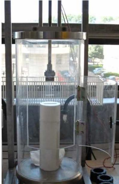
Figure II-1 : Dip-coater utilisé pour le dépôt des revêtements
