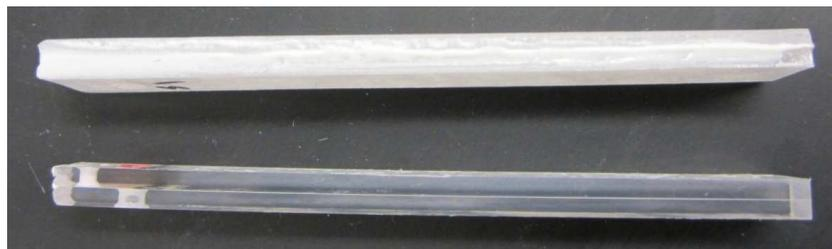
*Figure 8-2 : échantillons de DCB avant polissage (haut) et après polissage (bas)*
