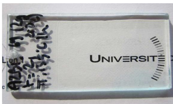
*Figure III-79 : photo de l'échantillon de PC recouvert du système A2-2 contenant 10%wt de la solution de particules de zircon fonctionnalisées GPTMS*
