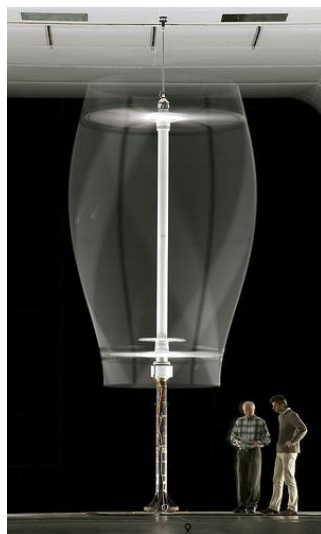
FIGURE 1.6 – La taille de la génératrice d'une VAWT par rapport au rotor et au mât.
