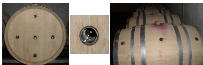
Figure 96 : Barriques expérimentales pour la mesure de l'oxygène dissous du vin CS/CF (93/7 (vol/vol))
