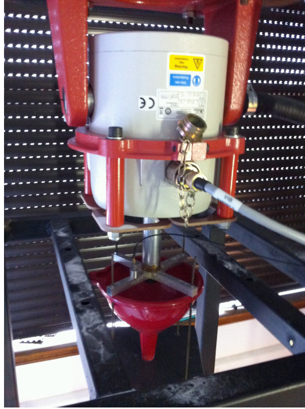
FIGURE 2.2 – Dispositif expérimental pour l'excitation du jet. L'accéléromètre est fixé sur la croix métallique de fixation de l'entonnoir.
