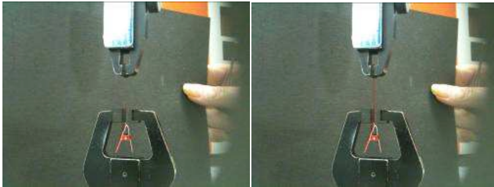
Figure II.8 : Tensile test by mono-column dynamometer (Dynamomètre mono-colonne)
