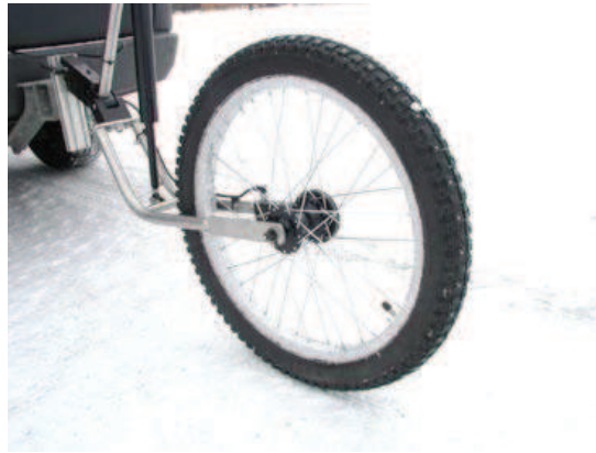
Figure 5.35 – Illustration des mesures de distance de freinage avec une cinquième roue
