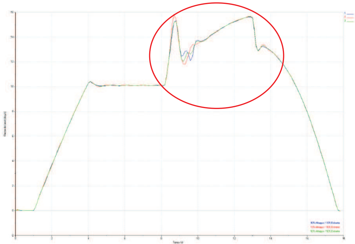
Figure A1.37 – Vitesse de lacet sur un freinage en courbe pour une répartition attaque/détente de la loi d'amortissement 90%/10% (bleu), 50%/50% (vert) et 10%/90% (rouge)
