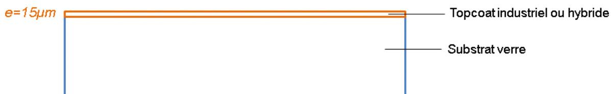
**Figure III-13 : Représentation schématique d'un dépôt de topcoat industriel ou hybride pour les essais d'indentation**
