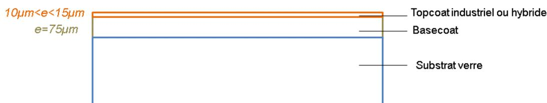
**Figure III-14 : Représentation schématique d'un dépôt de système de vitrification possédant un topcoat industriel ou hybride pour les essais de rayure**
