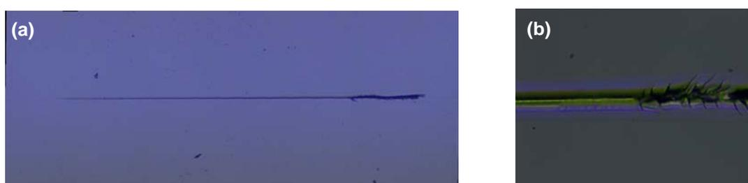
**Figure III-27 : Essai de rayure sur le système intégrant le topcoat MAPTMS/TEOS (80/20) - Observation par microscopie optique (a) de la rayure entière (730 µm x 260 µm) et (b) de la zone d'apparition des fissures (72 µm x 54 µm)**
