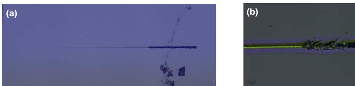
**Figure III-23 : Essai de rayure sur le système intégrant le topcoat industriel organique - Observation par microscopie optique (a) de la rayure entière ( $730\ \mu\text{m} \times 260\ \mu\text{m}$ ) et (b) de la zone d'apparition des fissures ( $72\ \mu\text{m} \times 54\ \mu\text{m}$ )**
