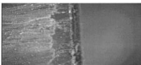
**Figure I-16 : Observation par microscopie optique (x30) du film SR 494 pur (à gauche) et du film SR 494 avec 35% de silice modifiée par le MAPTMS après 60 cycles de rayure à la paille de fer déposés sur un substrat en verre [20]**
