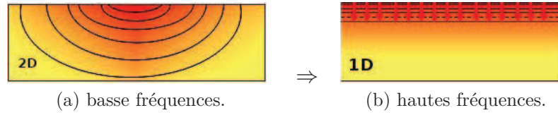
FIGURE 4.1.3: simplification de la géométrie des transferts de chaleur à haute fréquence dans un dépôt
