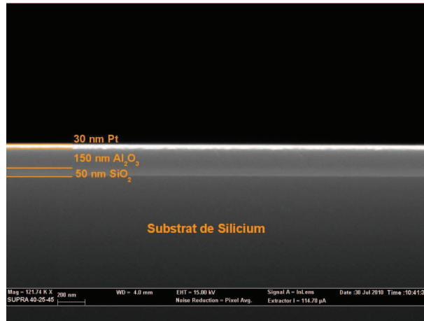
FIGURE 6.1.1: section transversale MEB d'un échantillon Si/SiO_2//Al_2O_3/Pt . Les épaisseurs sont aussi indiquées.
