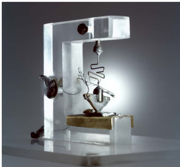
Figure 1-1 : Transistor amplificateur « point-contact » construit en 1947 par W. Shockley, J. Bardeen et W. Brattain (AT&T Bell Laboratories). Le prix Nobel de Physique leur sera décerné en 1956.
