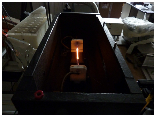
Figure 3.1 – A gauche : Photographie d'une décharge d'hélium. A droite : schéma de l'expérience.
