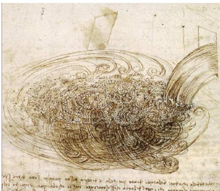
FIGURE 1.3 – Phénomène d'écoulement d'air turbulent observé par Léonard de Vinci.
