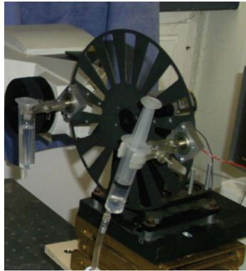
FIGURE 5.1 – Photo de la roue servant à créer l'écoulement sinusoïdal.
