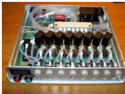
FIGURE 11.6 – Photo d'un MFCS-8C ouvert.
