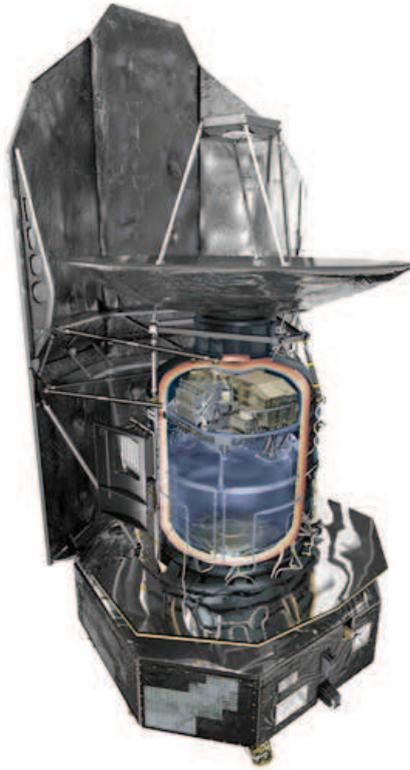
Figure 1.10 : Le télescope spatial Herschel et son miroir de 3,5 m. Vue du cryostat au sein d'Herschel surplombé par les trois instruments de mesures [(ESA), 2009].
