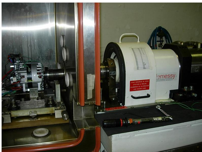
FIGURE IV.8 – Montage de la MSDE sur le banc à entraînement direct
