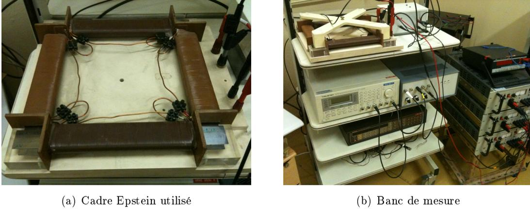
FIGURE V.3 – Banc de mesure - cadre Epstein
