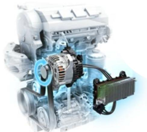
FIGURE 1 – Emplacement d'un alternodémarrateur
