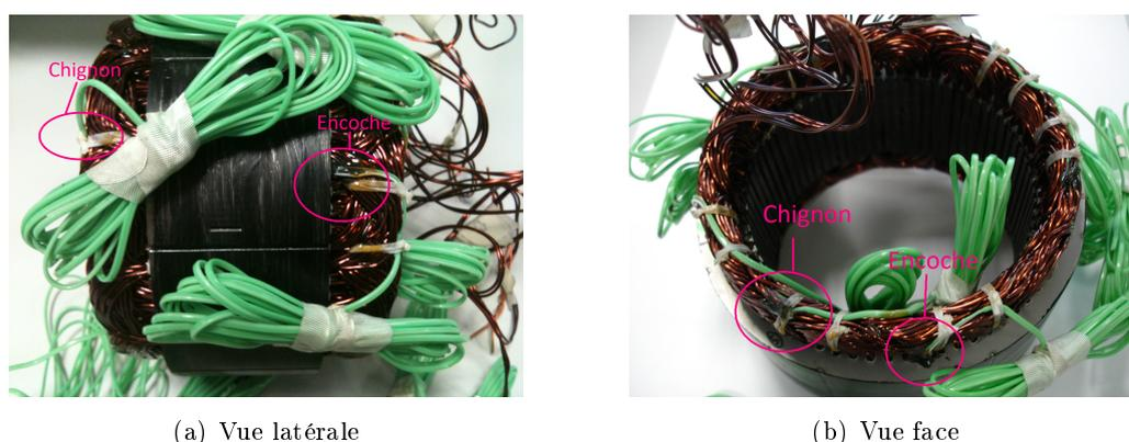
FIGURE IV.11 – Emplacement des thermocouples
