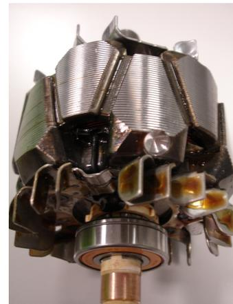
(b) Rotor d'une machine à griffes
