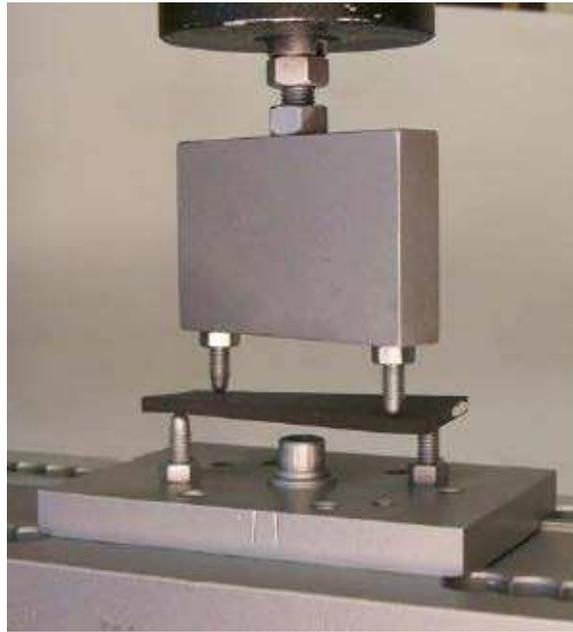
Figure 17. Montage de l'essai ECT [de Morais, A. B., 2009]
