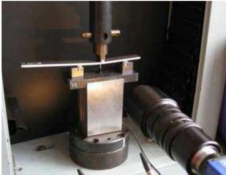
*Figure 14. Montage de l'essai ENF utilisé à l'Onera avec le dispositif de prises d'images [Hautier, M., 2010]*
