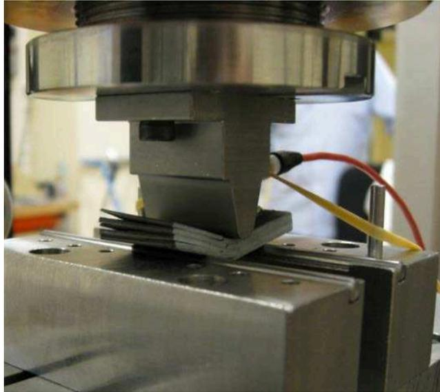
Figure 8. Montage utilisé à l'Onera pour les essais Short Beam Shear [Charrier, J. S., 2011]
