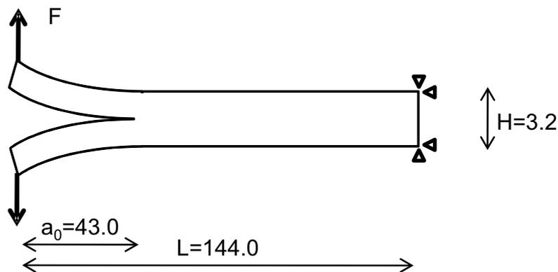
Figure 51. Représentation schématique des dimensions de l'éprouvette DCB et des conditions aux limites imposées
