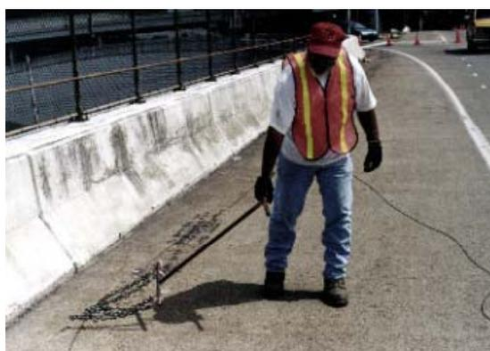
*Figure III. 3. Recherche de délamination sur une chaussée par la méthode de la chaîne glissée [SCH, 98]*
