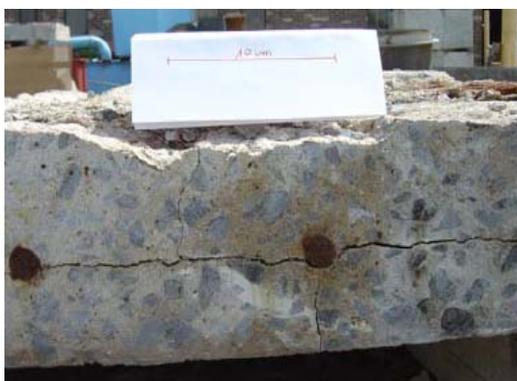
Figure III. 1 Délamination dû à la corrosion des armatures [NAA, 06]
