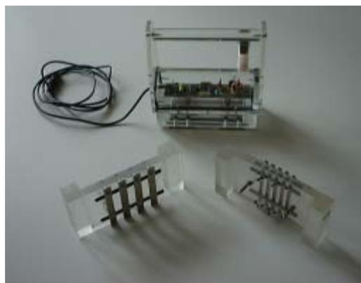
Figure IV. 6. Capteur capacitif associé à un jeu de trois électrodes
