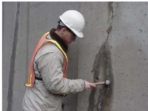
*Figure III. 4. Inspection d'une culée de pont par « Hammer sounding » [COL, 10]*
