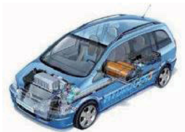
Figure I.19 : Véhicule hydrogen3 qui utilise un moteur à combustion interne. Le réservoir à hydrogène (stockage liquide) est représenté en orange sur la photo.
