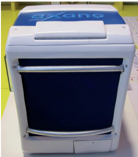
Figure I.18 : Exemples de pile à combustible ( PEMFC : Proton Exchange Membrane Fuel Cell 30°C-100°C) développée par Air Liquide (à gauche) et par Peugeot et le CEA (à droite).
