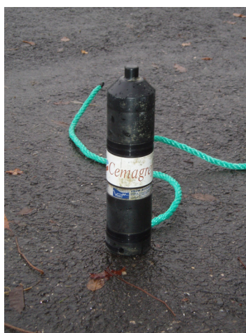
Figure 44 : Hydrophone autonome utilisé en poste fixe
