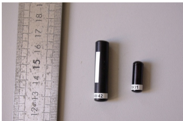
Figure 43 : Émetteurs acoustiques utilisés (V9 à gauche, V7 à droite)
