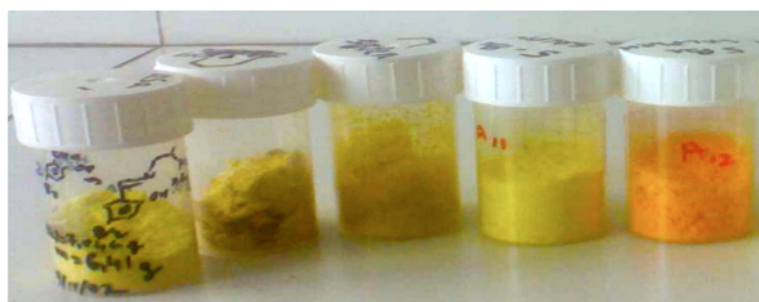
Figure SII.3 : Exemples de plusieurs ligands de type base de Schiff obtenues de gauche à droite : H_2salmen , H_2salpn , H_2salen , 5-Br- H_2salpn , 5-Br- H_2salphen .
