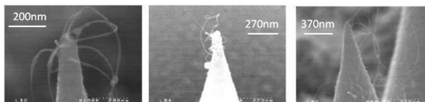
FIGURE 2.10 – Images MEB de SWNT synthétisés pointes AFM coniques avant optimisation.
