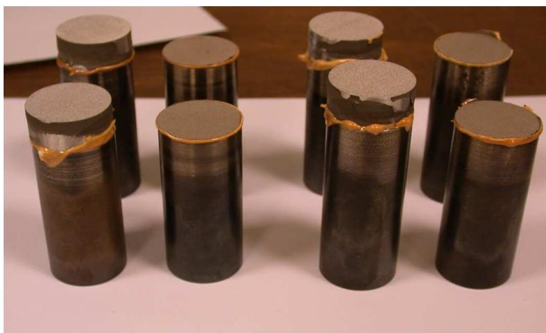
**Figure 3.36.** Interface de rupture après test de traction des substrats d'aluminium texturés et revêtus.
