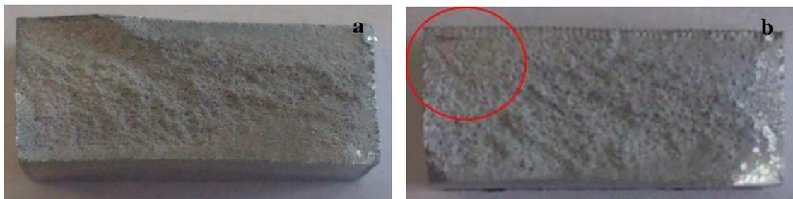
Figure 3.48. Faciès de rupture d'éprouvettes testées à une contrainte maximale de 36 kN et  $R = 0,1$  (a) vue d'ensemble typique de surface rompue sans zone de rupture claire, (b) vue d'ensemble d'une zone de rupture claire par fatigue
