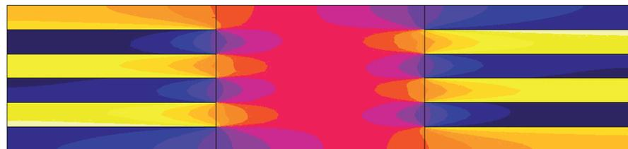
FIGURE C.6 – Carte du module de l'induction pour  $\beta = 90^\circ$  à 1 T
