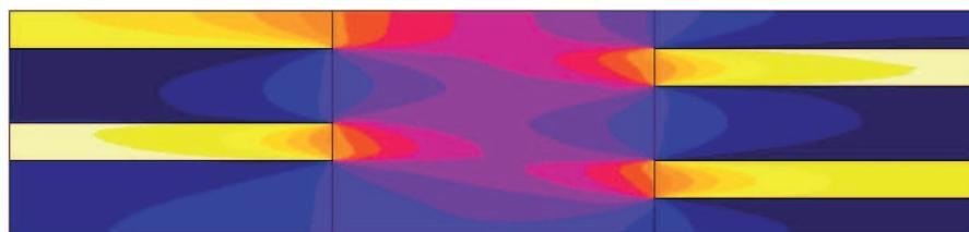
FIGURE C.5 – Carte du module de l'induction pour  $\beta = 60^\circ$  à 1 T
