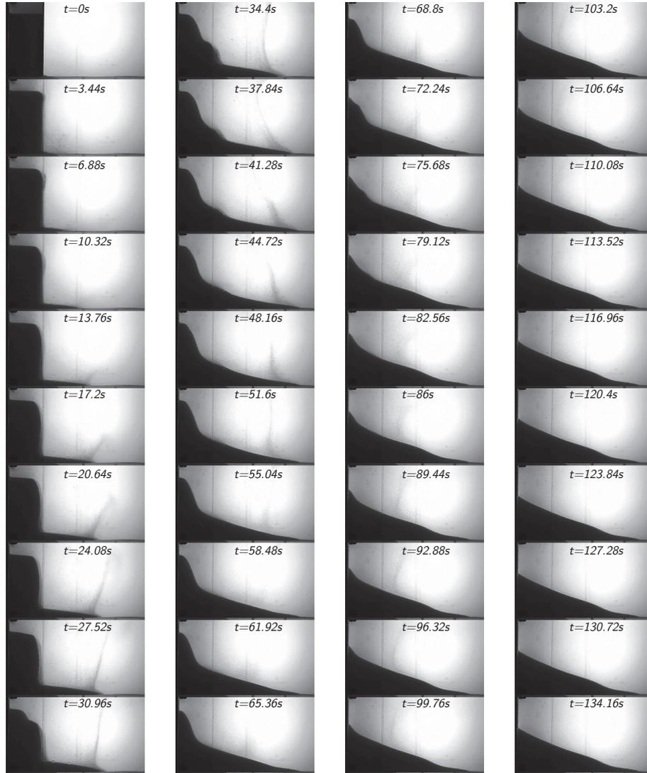
FIGURE 2.8 – Effondrement d’une colonne de grain  $H_i = 8\text{cm}$ ,  $L_i = 4\text{cm}$ ,  $\phi_i = 0,61$  et  $\eta_f = 12cP$ . La chronologie est de haut en bas puis de gauche à droite.
