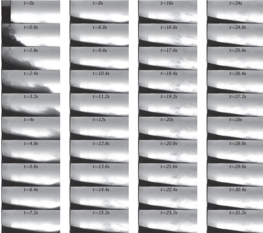
FIGURE 2.7 – Effondrement d’une colonne de grain  $H_i = 8\text{cm}$ ,  $L_i = 4\text{cm}$ ,  $\phi_i = 0,55$  et  $\eta_f = 12cP$ . La chronologie est de haut en bas puis de gauche à droite.
