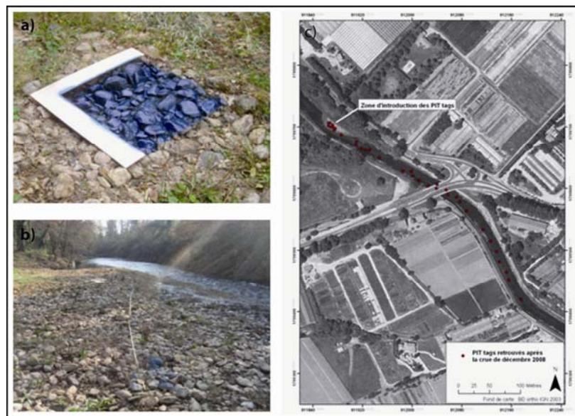
Figure 80 : a) Placette peinte avant et b) après une crue de  $42 \text{ m}^3/\text{s}$  sur le site n°3, c) exemple de localisation des PIT tags après la crue de décembre 2008 sur le site n°4.
