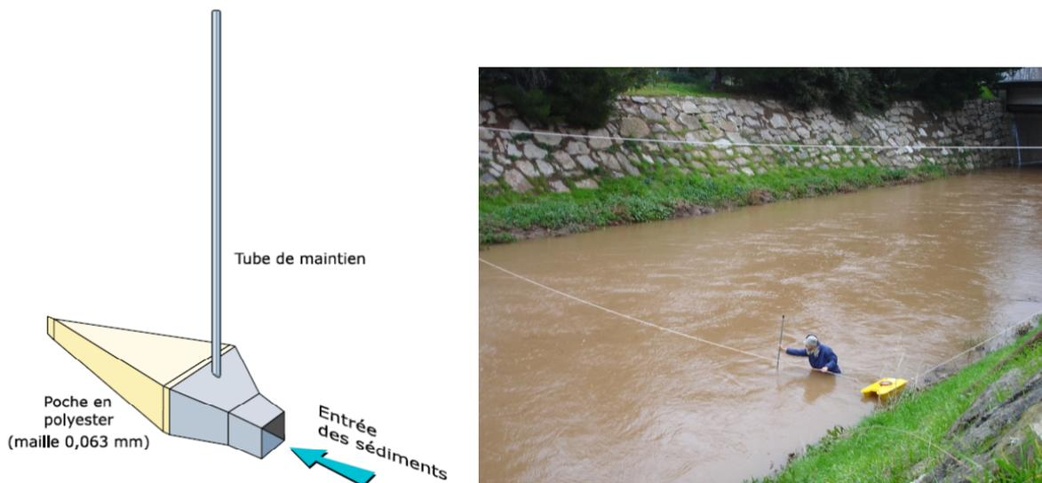
Figure 97 : Représentation schématique du piège Helley-Smith (Antonelli, 2004).
