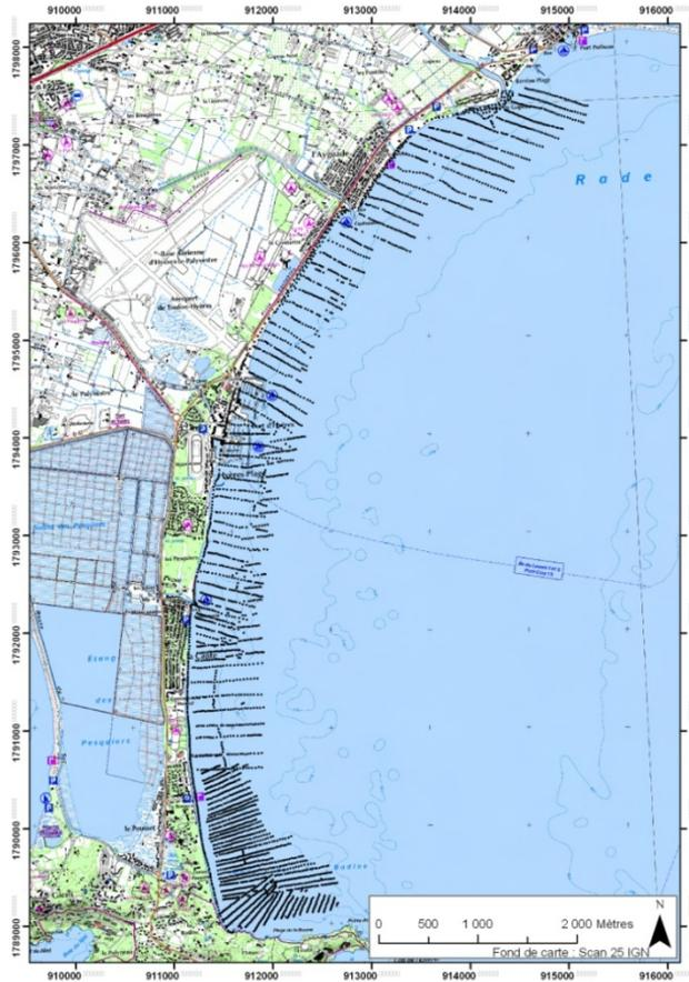
Figure 48: Semi de sondes de 1896 numérisées en rade d'Hyères (source : SHOM).
