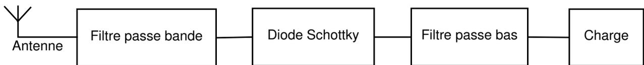
**Figure II.32** – Schéma bloc d'une rectenna
