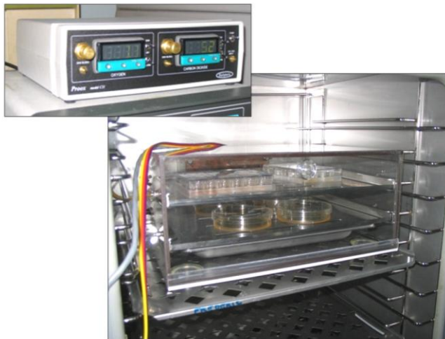
Figure 38. Chambre à hypoxie à l'Unité U828: La chambre est installée dans l'incubateur à cellules. Elle est reliée par câbles au boîtier de réglage, à l'extérieur, où s'affiche le niveau d'O 2 demandé et le niveau mesuré, en pourcentage. La bouteille d'azote est reliée au boîtier.
