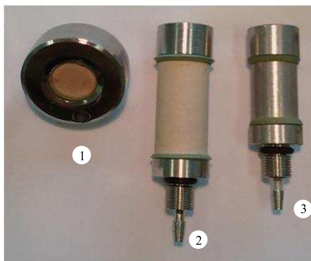
Figure 4.1. Micro-oxygénateurs utilisés : 1 - disque céramique barrique, 2 - tube céramique, 3 - tube inox
