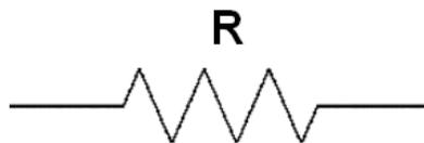
Figure II-17 : Symbole d'une résistance dans le simulateur SPICE.
