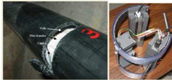
Figure I- 2 : (a) Gaine de précontrainte extérieure en PEHD
