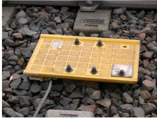
Fig. 1. 1. Balise KVB fixée sur la voie ( www.lebmodelisme.com )
