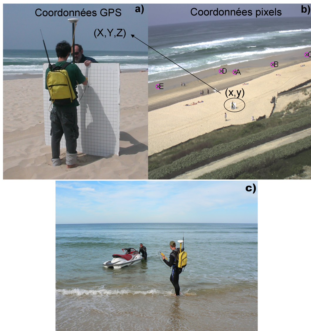
FIGURE III.3 – Mesure des points de référence pour le géoréférencement des images vidéo (Biscarrosse, septembre 2007) : (a) enregistrement des coordonnées GPS et (b) localisation des coordonnées pixels correspondantes. Les cercles indiquent les estimations produites par la rectification et les croix les points de référence. (c) mesure des points de contrôle en mer.
