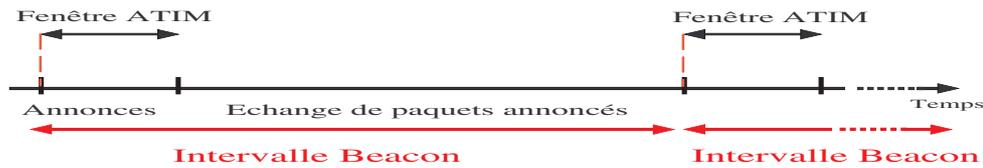
Figure 4.1 – Structure d'un intervalle beacon pour le mécanisme PSM
