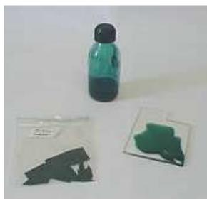
**Figure 4.5 : Photographie des composites de Pani-CSA/PU.**
