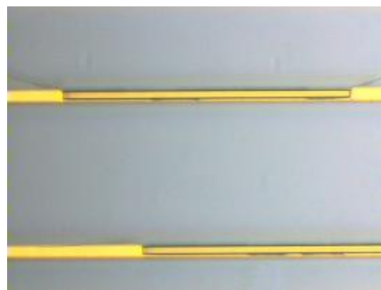
Ouvertures dans la résine au-dessus des électrodes de guides droits métallisés.
