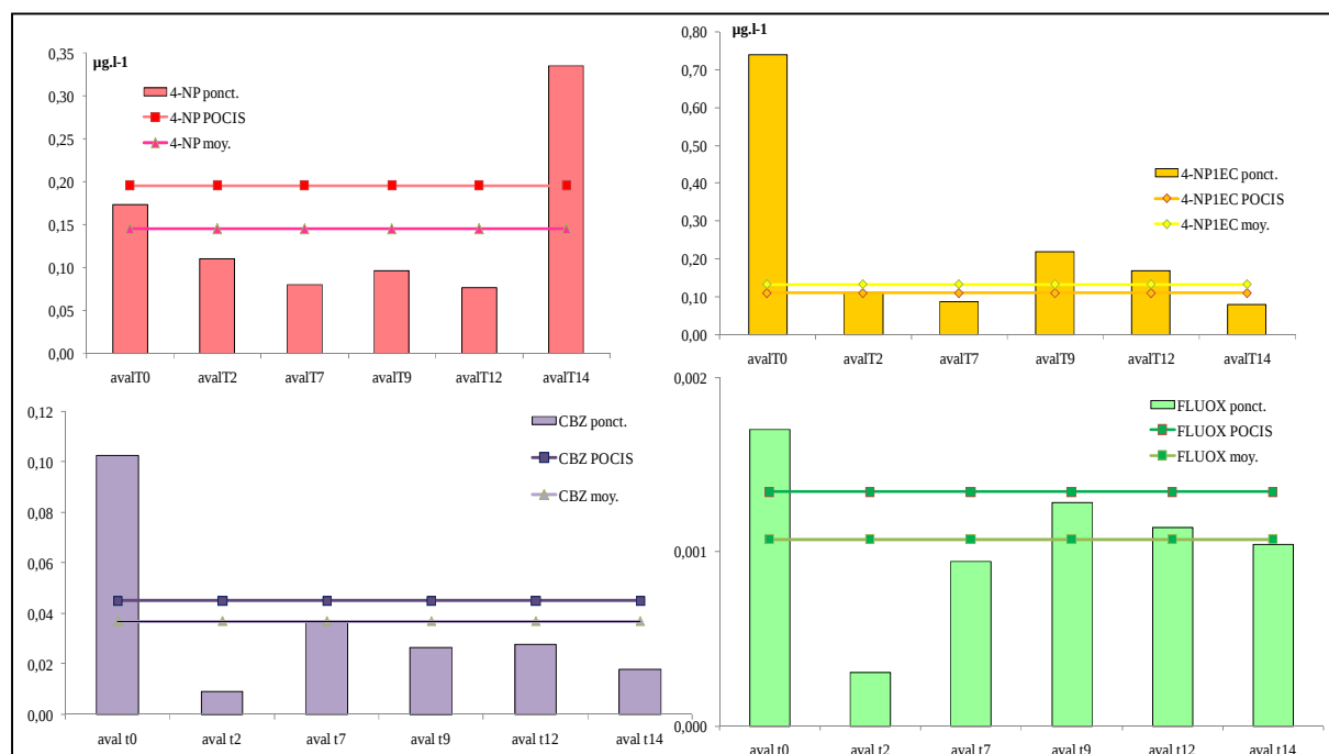
Figure 67 : Comparaison des données obtenues par prélèvements ponctuels et échantillonnages intégratifs lors d'une étude de 14 jours au niveau de la Jalles d'Eysines.
