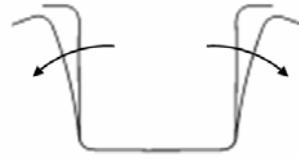
**Figure I.8.** Effet du retour élastique sur une structure crash-box réalisée par emboutissage
