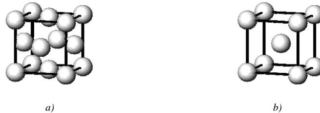
**Figure I.10.** Structures cristallographiques a) Cubique Face Centré (CFC) b) Cubique Centré (CC)
